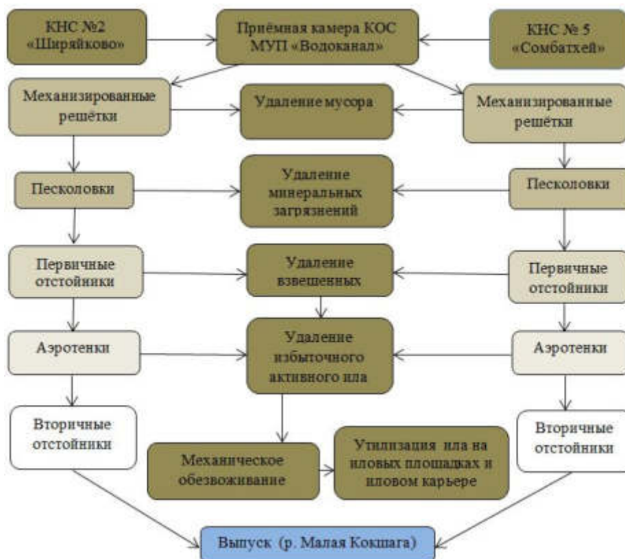
Рисунок 1.55 Принципиальная схема очистки сточных вод на КОС МУП «Водоканал».
