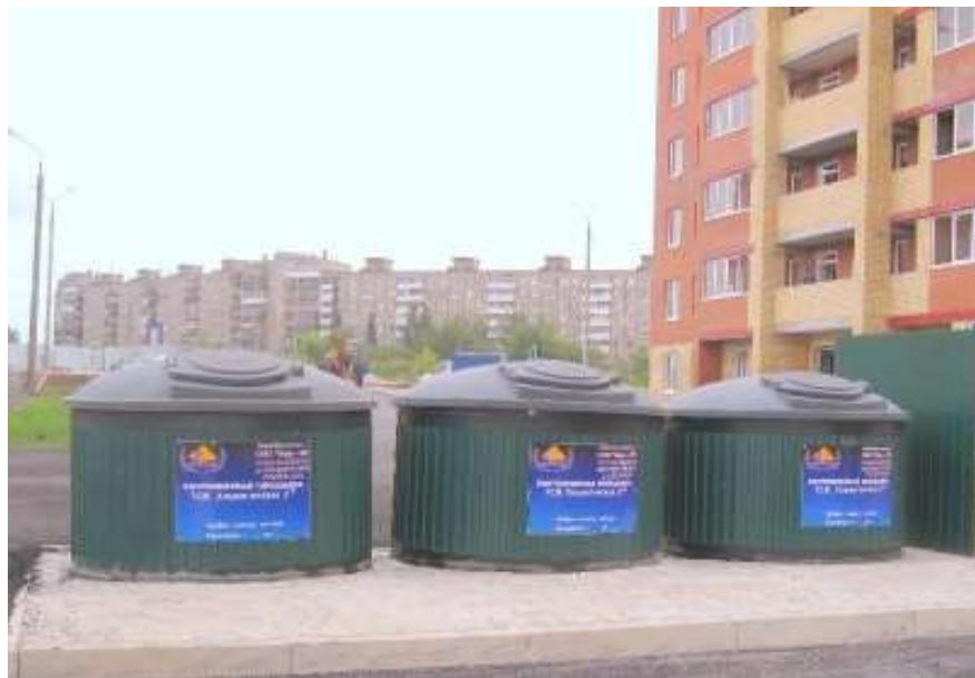
Рис. 3. Контейнерная площадка с заглубленными контейнерами объемом 5 м<sup>3</sup> в многоэтажной застройке
